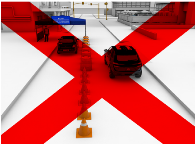
Fig. 6 - Instalación incorrecta en carril de alta
