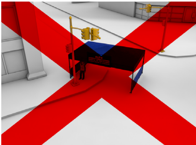
Fig. 7 - Instalación incorrecta en curva
